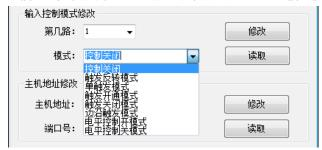
用【设备参数修改 V3.5】软件,先连接到控制器,在【输入控制模式修改】进行修改某几路,和输出动作方式,下面列表中介绍这几种模式,对本功能的使用,在控制器的版本不同,修改后可能需要对控制器重启或不重启,用户可自行测试。
