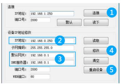
想办法用电脑的网卡与控制器直连,不需要经过路由器,交换机等,需要将 WIFI 进行禁用,是禁用,然后手动分配一个 IP 地址给本地网络,使电脑的 IP 地址的网关在 192.168.1.1,或 192.168.0.1 这两项,这两项根据跳线 1 和 3 选择的,这样就与控制器保持在同一网关内,电脑就可以与控制器相连接,能连接才可以给控制器修改分配新的 IP 地址。
