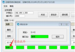
【上图左】为输出端每一路的改名方法,【上图右】为输入端 X 的改名方法,点修改后,将名称保存在芯片内存,对控制器断电、复位出厂等各种方式不影响,只能通过再次修改才能改变。J1605 没有输入功能,对右图的修改并无意义。
