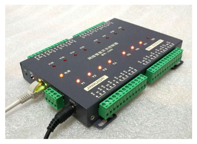
型号 J1605 是一款通过 TCP 网络方式,使用客户端软件在 PC 端、APP 手机端、组态软件或中控,通过大小型局域网或广域网直接连接,远程控制 16 路继电器开关带动负载,还提供 RS485 同时控制。控制器内置了 16 个独立的继电器开关,16 路开关可分别控制,集中控制,控制器内置实时时钟,内置电池,可以通过 PC 客户端软件预约固定时间自动开关功能,内置每路 AC220V/10A 继电器,可以控制灯光照明,或控制交流接触器来增加大功率负载,和控制三相电气设备。本控制器除了提供客户端软件直接使用,还提供了大量二次开发组件,供系统集成。
