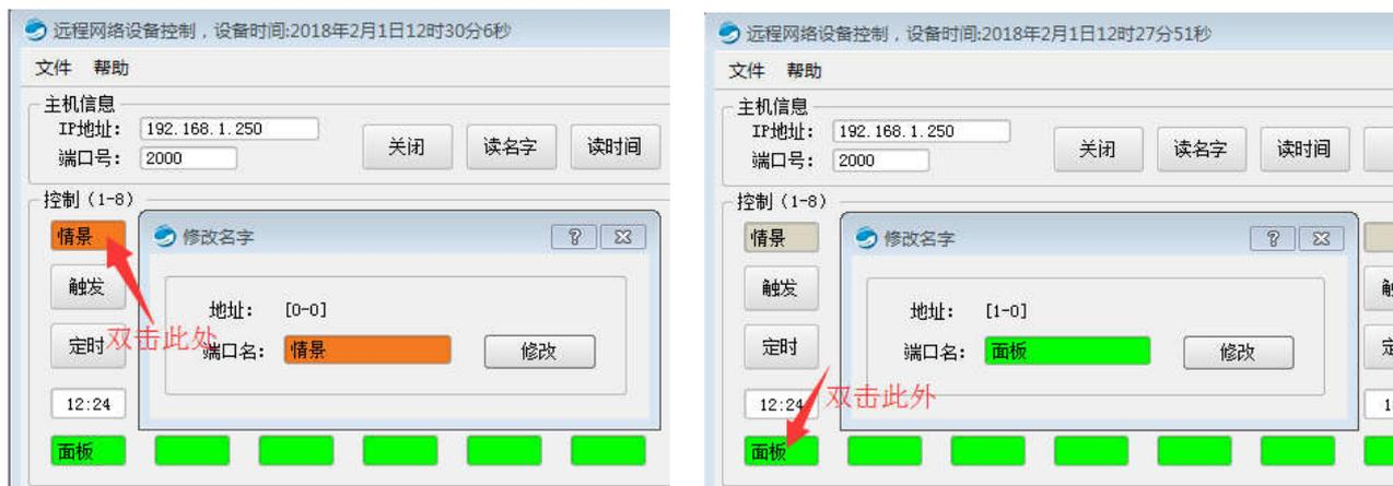
【上图左】为输出端每一路的改名方法，【上图右】为输入端X的改名方法，点修改后，将名称保存在芯片内存，对控制器断电、复位出厂等各种方式不影响，只能通过再次修改才能改变。
