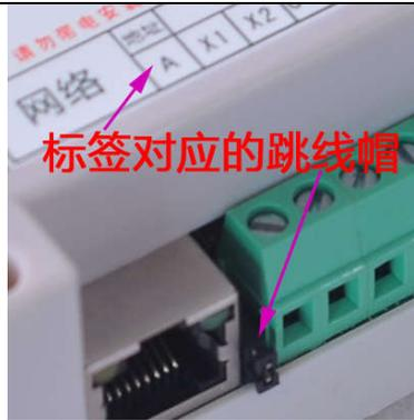
**默认 IP 地址：**是将控制器设置为出厂的模式，我们就可以确实的知道控制器的 IP 地址是多少，知道了就可以进行连接，能连接才可以重新设置新的 IP 地址，所以用户遇到连接不上的情况，那就可以用此方式操作连接，再重新修改。IP 地址没有软件进行修改，或没有拔插跳线帽切换，是不会因为其它原因而自动改变。
