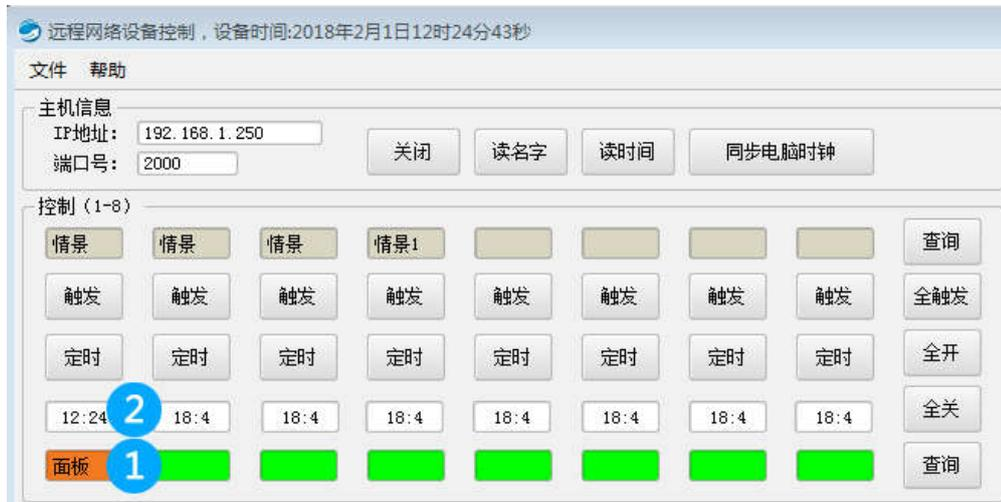
上图 1 表示信号输入 X 的显示开关态，当有输入时显示橙色，当无输入时显示绿色，上图 2 表示检测输入 X 的最后一次的时间，检测时间，这个时间必须软件正在打开并正在连接时才能检测到输入最后一次时间，这些时间保留最后一次，没有长期的记录，也没有特别用途。
