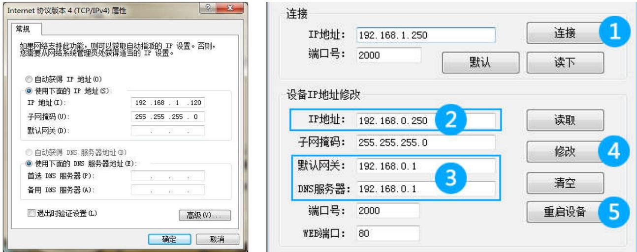
想办法用电脑的网卡与控制器直连，不需要经过路由器、交换机等，需要将 WIFI 进行禁用，是禁用，然后手动分配一个 IP 地址给本地网络，使电脑的 IP 地址的网关在 192.168.1.1，这样就与控制器保持在同一网关内，电脑就可以与控制器直接，能连接才可以给控制器修改和分配新的 IP 地址。
