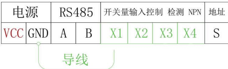
不管采用各种各样的开关, 都是将 GND 的信号送至 X, 而上图, 直接用一根导线, 从 GND 引至 X 同样也是可以, 开始使用时可直接用导线做试验, 当应用比较复杂时, 只要想办法将 GND 的信号送至 X 即可提供信号给控制器。比如上面介绍的机械式开关, 自复位开关等,
